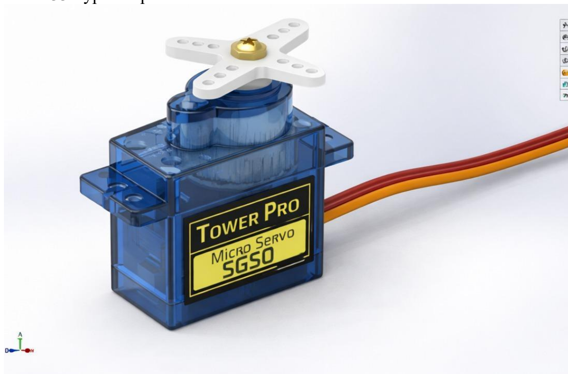
Сурет 33 – SERVO SG90 сервожетектің 3Д сұлбасы
