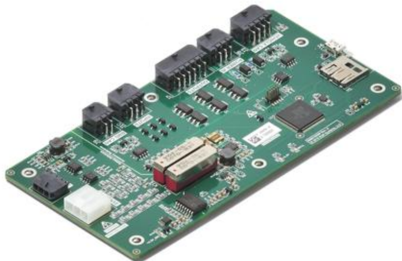
Сурет 28- Аккумуляторды басқару жүйесі
